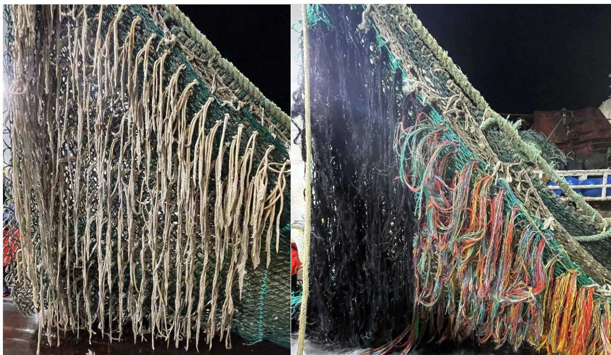
Bilde 21. Trefiberlabbetuss og vanlig labbetuss etter 49 hal (Bilde: Simon Eliseussen).
