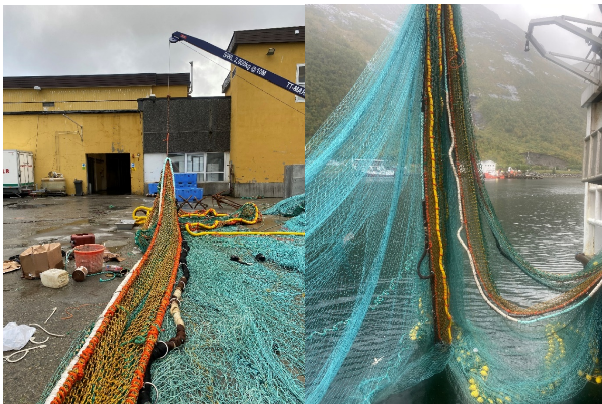
Bilde 11. Sabben er ferdig bolses med trefibertau til venstre på første bildet og kuskinn til høyre på første bildet, og motsatt på andre bildet (Bilde: Jørgen Vollstad).
